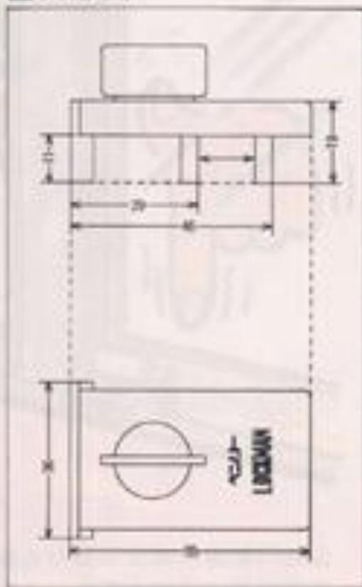
※サッシどめベンリーロックマンを別個の窓わく、かまちとの間、又は水かえし枠との間に差し込んで金具をサッシわくに押しつけながらつまみを回わして下さい。
